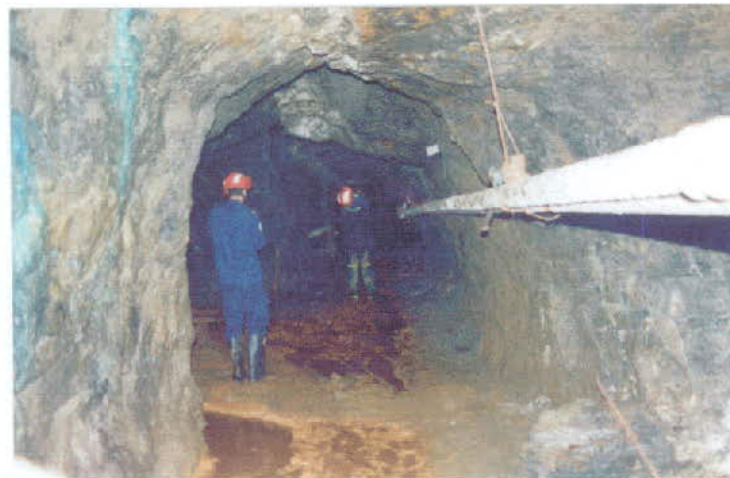
Fig. 6.16. Pormenor de um das galerias de exploração perto do poço mestre. As escorrências azuladas são do sulfato de cobre que nalguns pontos forma, juntamente com os óxidos de ferro e carbonatos, pequenas estalactites.
